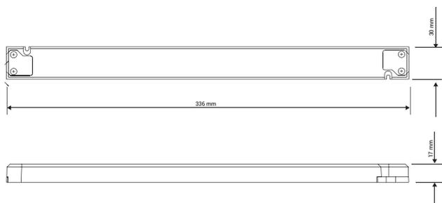
Alimentatori Serie LT con layout tipo ballast e contenitore in plastica
